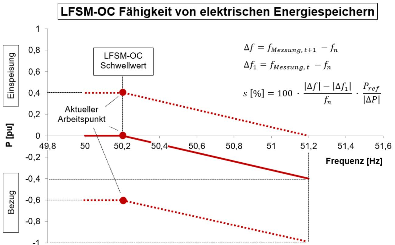
Abbildung 2: Fähigkeit von elektrischen Energiespeichern zur frequenzabhängigen Anpassung der Wirkleistung im LFSM-OC-Modus (Darstellung für  $P_{ref} = P_{max}$ )<sup>14</sup>
