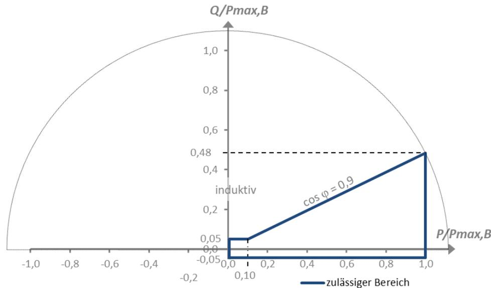
Abbildung 6: Zulässiger Blindleistungsbereich für Kundenanlagen ( $Q$  ist die Blindleistung der Kundenanlage in var,  $P$  ist die Wirkleistung der Kundenanlage in W,  $P_{max,B}$  ist die maximale Bezugskapazität der Kundenanlage in W und  $\cos \varphi$  ist der Verschiebungsfaktor)
