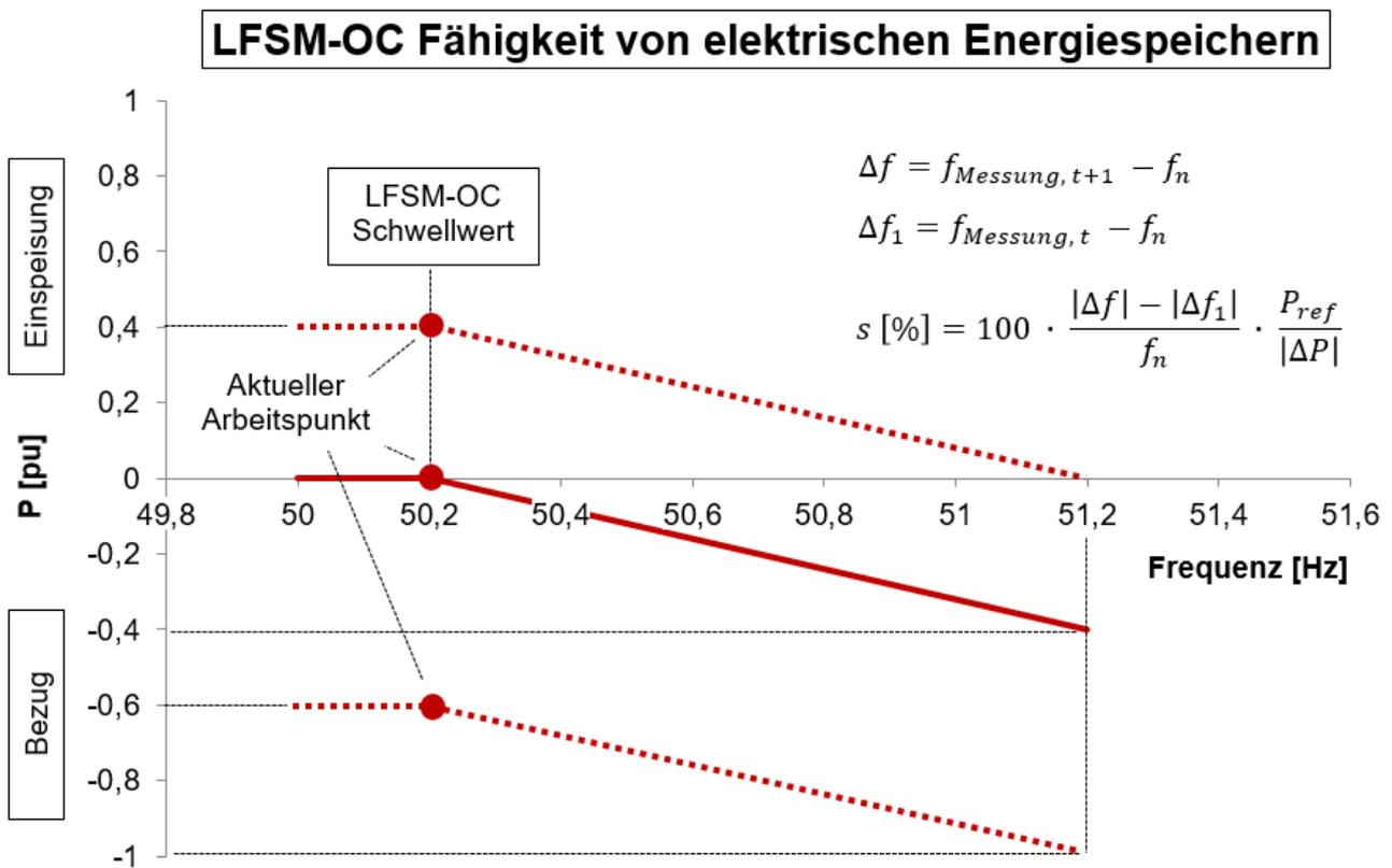
Abbildung 2: Fähigkeit von elektrischen Energiespeichern zur frequenzabhängigen Anpassung der Wirkleistung im LFSM-OC-Modus (Darstellung für  $P_{\text{ref}} = P_{\text{max}}$ )<sup>12</sup>
