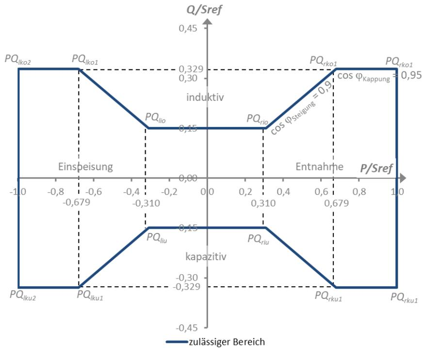
Abbildung 7: Zulässiger Blindleistungsbereich für Verteilernetze mit Verteilernetzanschluss (Q ist die Blindleistung des Verteilernetzes in Mvar, P ist die Wirkleistung des Verteilernetzes in MW, S<sub>ref</sub> ist die Referenzscheinleistung in Mvar und cos φ ist der Verschiebungsfaktor.)
