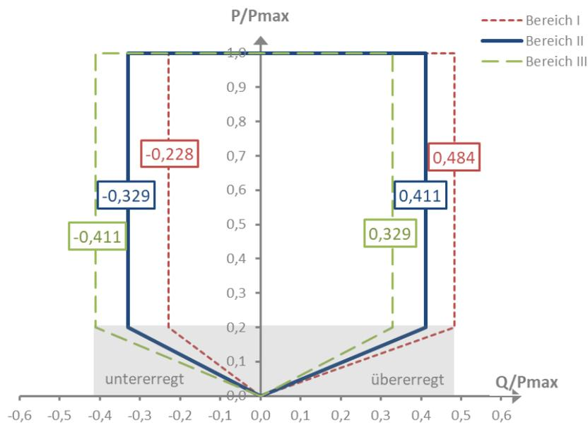
Abbildung 11: Blindleistungsbereiche nichtsynchrone Stromezeugungsanlagen unterhalb der Maximalkapazität
