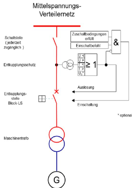
Abbildung 13: Netzanschluss an das Mittelspannungsnetz mit Netzentkupplungsschutz
