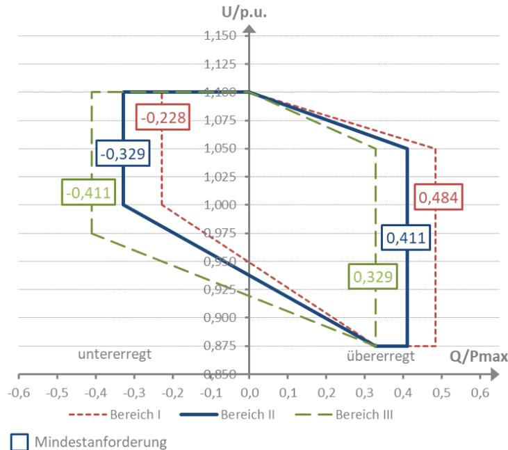
Abbildung 10: Blindleistungsbereiche synchroner und nichtsynchrone Stromerzeugungsanlagen bei Maximalkapazität
