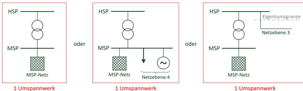
Abbildung 3-2 Beispiele für zu erfassende Umspannwerke, HSP/MSP
