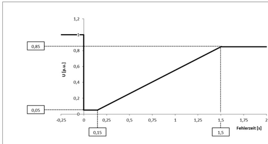
Abbildung 10: FRT-Profil nichtsynchrone Stromerzeugungsanlagen
