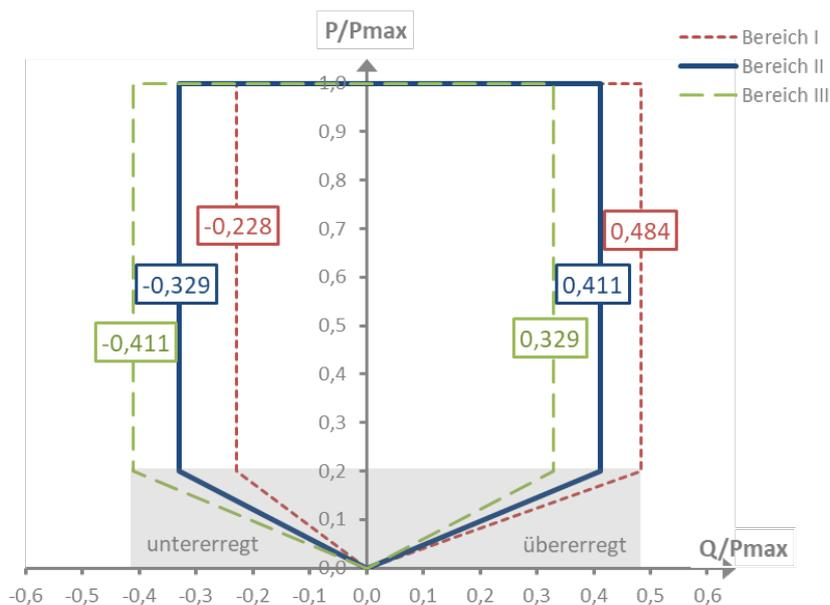
Abbildung 14: Blindleistungsbereiche nichtsynchrone Stromerzeugungsanlagen unterhalb der Maximalkapazität
