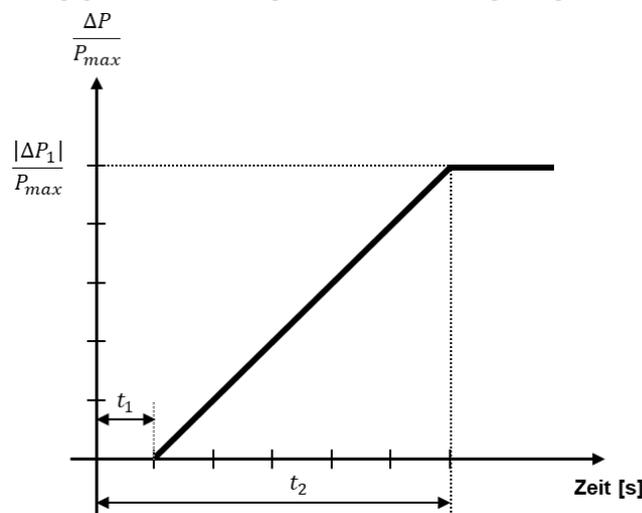
Abbildung 8: Fähigkeit zur frequenzabhängigen Anpassung der Wirkleistungsabgabe
