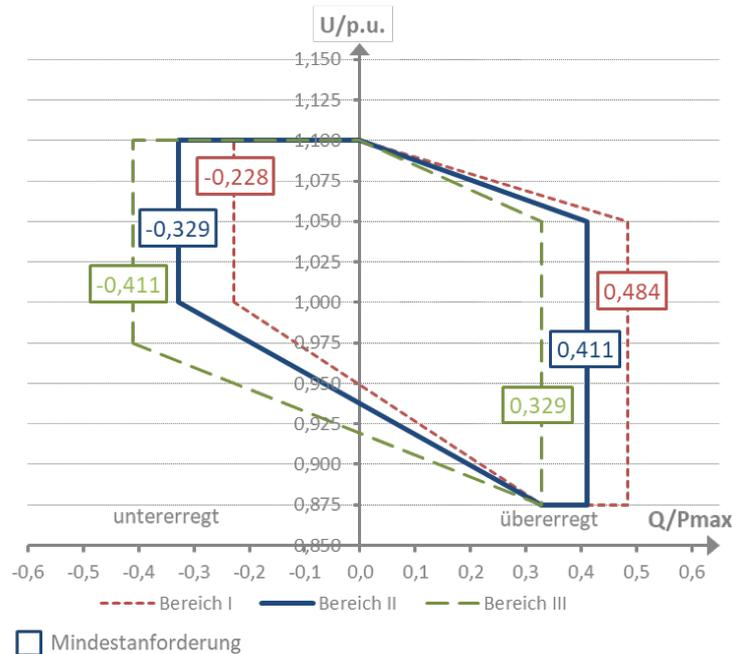
Abbildung 13: Blindleistungsbereiche synchroner und nichtsynchrone Stromerzeugungsanlagen bei Maximalkapazität
